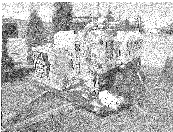
Zdj. nr 2. Piaskarka bezpyłowa Quill Falcon 60T
